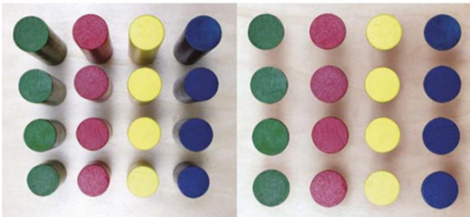
Abbildung 3: Abbildung durch ein gewöhnliches Objektiv links zeigt Perspektive. Die gleichen Gegenstände werden von einem telezentrischen Objekti so abgebildet, wie man sie aus dem unendlichen sehen würde, ganz ohne perspektivische Verzerrung.
